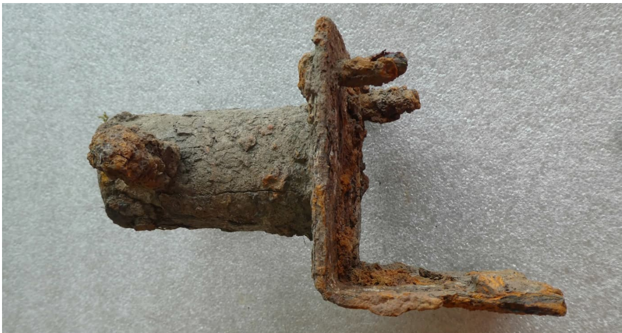
Figuur 31. Het los gevonden ijzeren boldertje dwars gezien. Hier is goed te zien dat dit op een hoekijzer heeft gezeten (waarschijnlijk de bovenrand van het wrakje). Ook zijn er 2 pennen, bouten of nagels zichtbaar om het boldertje vast te maken op het schip (Janneke Bos)
