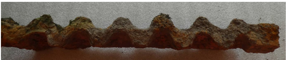
Figuur 24. Zicht op de bovenzijde van de geribbelde ijzeren staaf (Janneke Bos)
