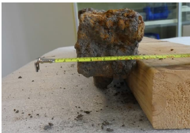
Figuur 29. De lip van de ijzeren staaf naast een rolmaat zodat zichtbaar is hoe groot de afmetingen van de lip zijn (Janneke Bos)
