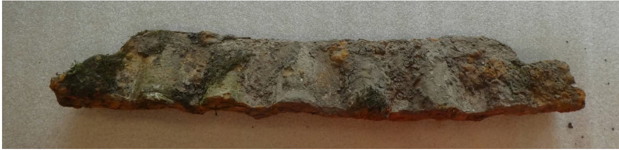
Figuur 20. De losse geribbelde ijzeren staaf. De staaf is aan de uiteinden voorzien van een schuine zijde zodat het ergens in gehangen kan worden. De ribbels van de staaf zijn taps, aan de onderzijde dunner dan aan de bovenzijde. De onderzijde van de staaf zit op deze foto boven, de bovenkant van de staaf zit op deze foto onder (Janneke Bos)
