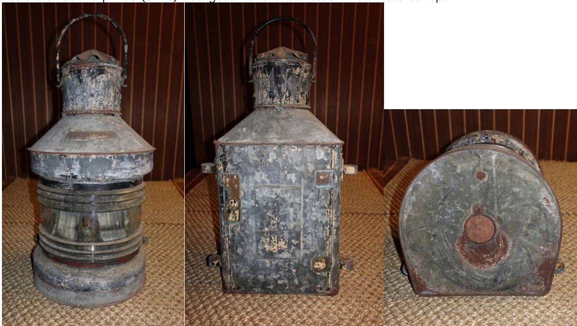
Figuur 41. Een voorbeeld van een compleet toplicht (groter (53x31 cm) dan het exemplaar in het depot), op de schuine bovenkant staat op een plaatje het woord 'toplicht' (internet 2 )
